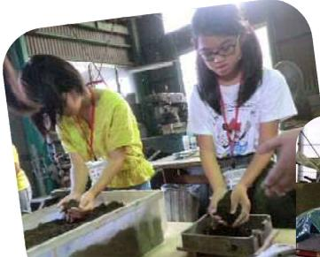
①枠の中に置いたロウ型の上に砂をしっかりと敷き詰めたらひっくり返して…
