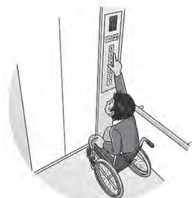
△エレベーターに車いす用ボタンがなく、手が届かない
