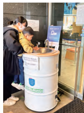
△同じ水を何度でも再利用できるシャワーシステムと手洗機
