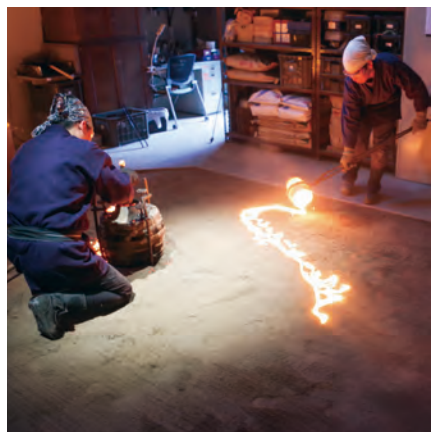
写真左上：1400度にもなる高温の溶けた鉄を鑄型に流し込む八木さん
