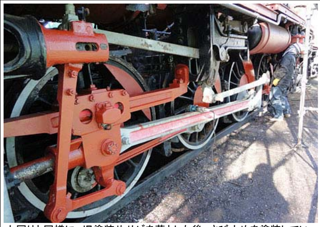
上回りと同様に、旧塗装やサビを落とした後、さび止めに塗装していきます。
