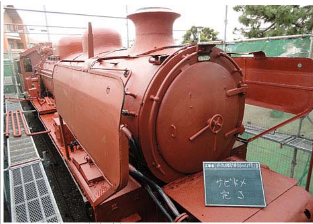
いよいよさび止め塗装が完了しました。
