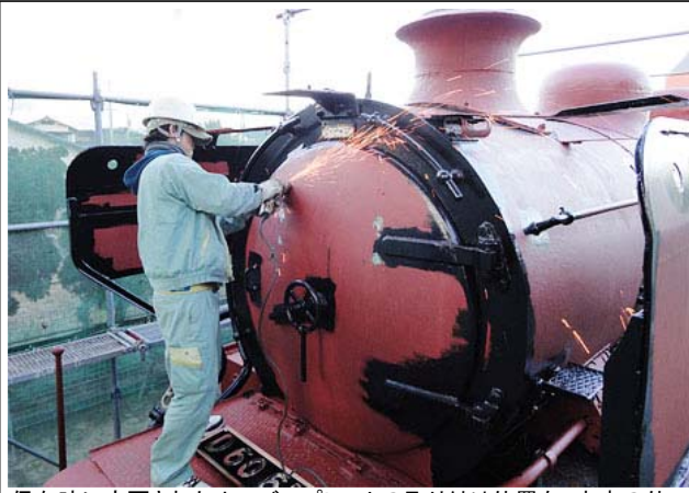
保存時に変更されたナンバープレートの取り付け位置を、本来の位置に復元する様子です。保存に際して、現役時代よりもかなり下方にナンバープレートが取り付けられましたので、気むずかしい怒ったような顔つきになってしまい、皆さんがご存知のD6061とは別人ようになっていました。
