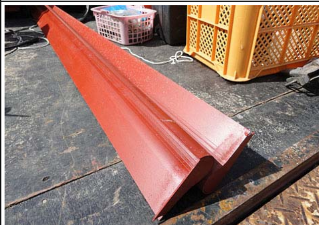
新しく製作した運転室屋根の雨樋です。
