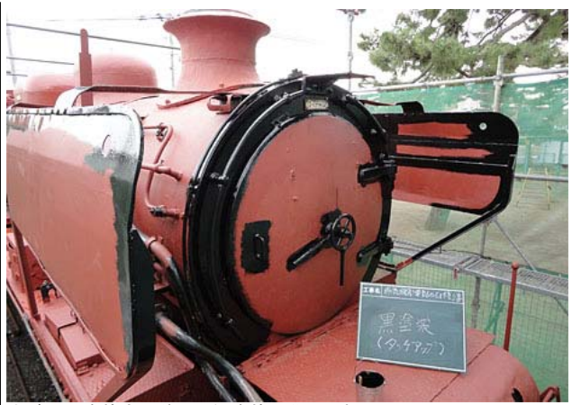
さび止め塗装完了後、黒色塗装に移ります。
