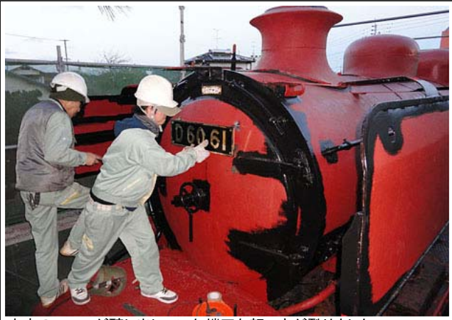
本来のD6061が醸し出していた端正な顔つきが甦りました。写真は取り付け台座の位置合わせのため、一時的にナンバープレートを仮止めしている様子です。
